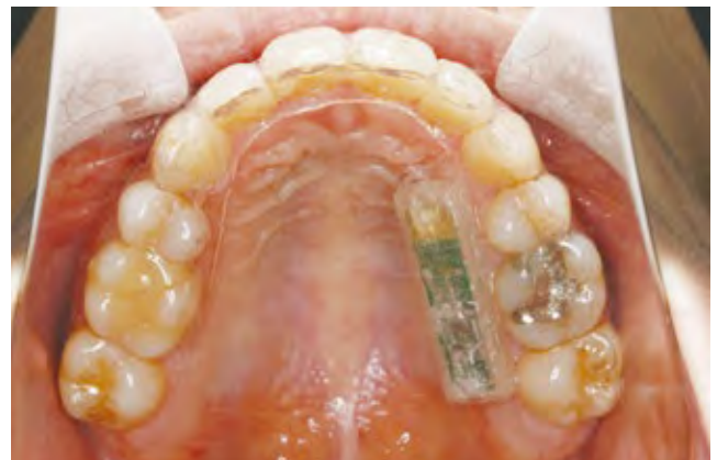
図 温度センサ付きセンシングデバイスを付属した アライナー型矯正装置
