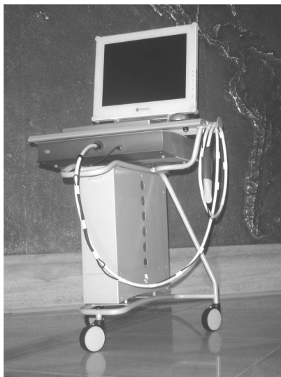
図3 エナメル質の脱灰-再石灰化を測定する器械 (QLF™)
