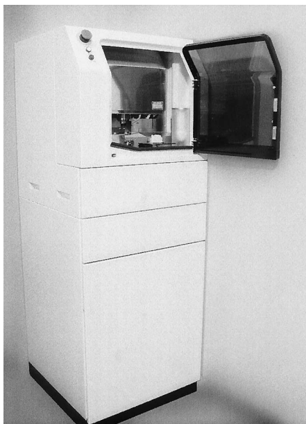
図1 コンパクトな歯科用キャドキャム装置の外観。1台に計測装置、パソコン、切削装置が組み込まれている
